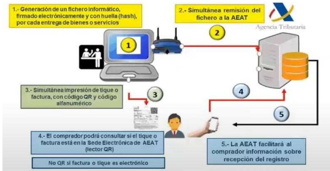
Esquema del funcionamiento de un sistema Verifactu . Fuente: AEAT
